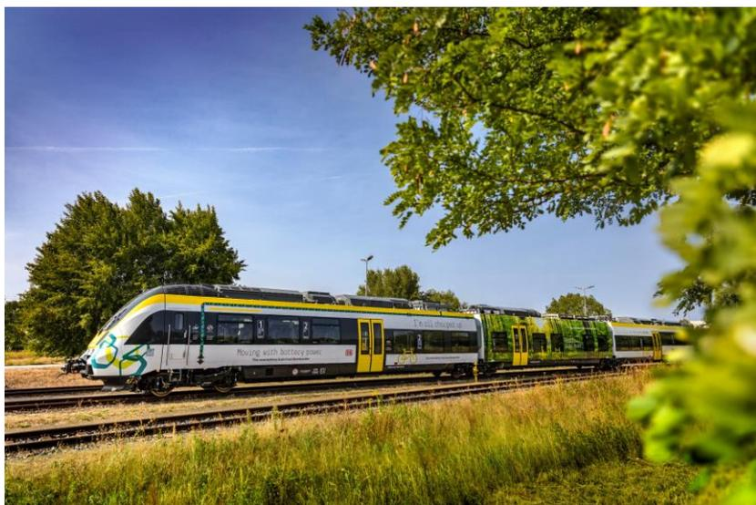
Les trains BOMBARDIER alimentés par batteries fonctionnent sans émissions et contribuent ainsi de manière significative à une mobilité respectueuse de l'environnement. Ils peuvent être utilisés pour relier des lignes non électrifiées et remplacer ainsi les trains diesel par des véhicules propres.
