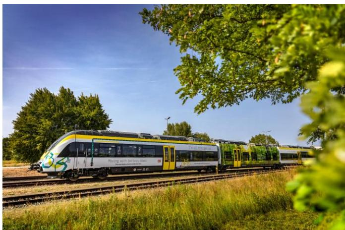
Der elektrische Triebzug von Bombardier mit Batterie arbeitet emissionsfrei und leistet damit einen wesentlichen Beitrag zur umweltfreundlichen Mobilität. Er kommt zum Einsatz, um nicht elektrifizierte Linien zu überbrücken und Dieselmotoren durch saubere, batteriebetriebene Fahrzeuge zu ersetzen.
